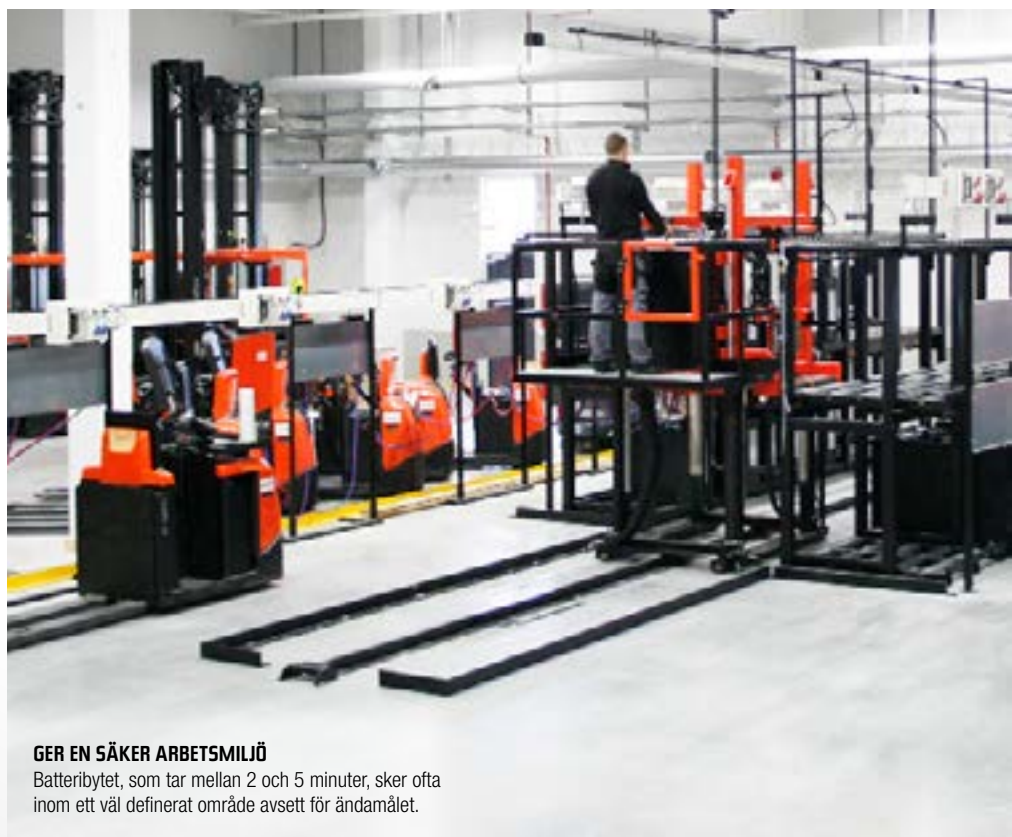
Vagn för batteribyten, i rullarna sitter Internordics rullgavellager.
